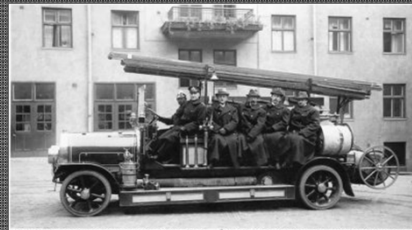
A8 Motorspruta Scania-Vabis DLA/special Årsmodell 1915 i tjänst mellan 1915-1931 Pump: Rag 1500L/min
